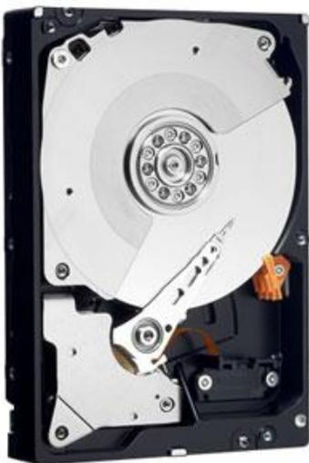
ハードディスクの中身は写真の様に2.5インチと3.5インチのアルミやガラスに塗布された磁気円盤を回転させ、ヘッドで書き込みと読み取りを行う。
